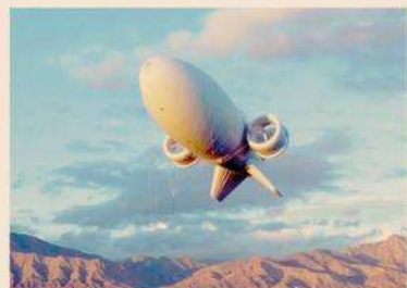
Cina. Il sistema eolico d'alta quota S4000 della start-up cinese Sawes
